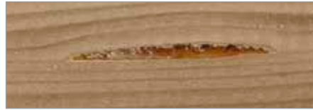
Harzgallen mit Entharzer entfernen
