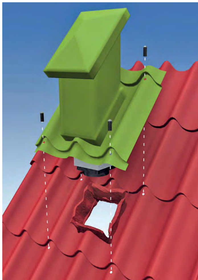
Befestigung des Lüfters
