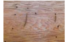
„Pinholes“ bei überseeischen Harthölzern
