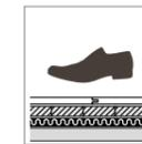
4. Einen besseren Trittschallschutz erreicht man durch mineralische Dämmstoffe. Empfehlenswert sind Glaswollämmstoffe. Bei erhöhten Anforderungen an den Trittschall bitte handelsübliche Federschienensysteme zur Schalldämpfung verwenden.
