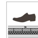
4. Ein besserer Trittschallschutz wird durch mineralische Dämmplatten erreicht.
